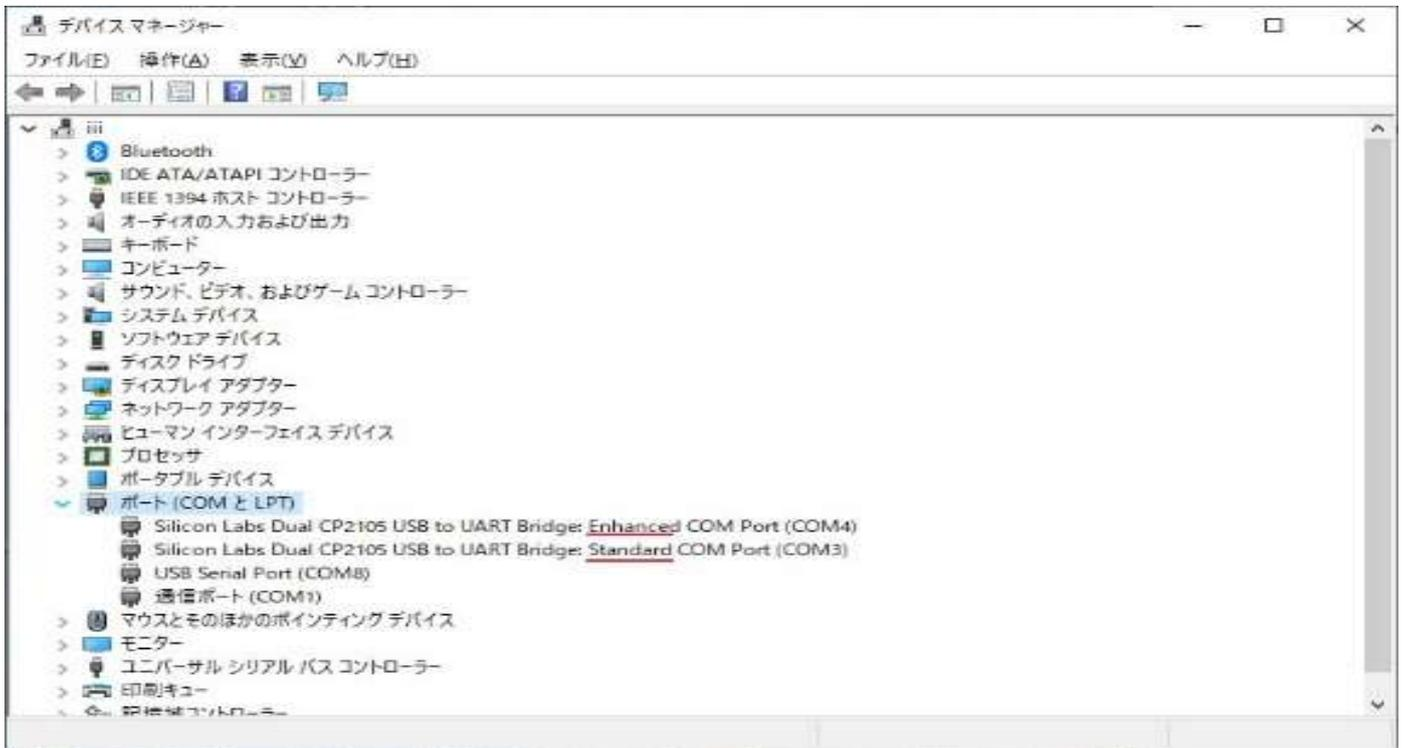
デバイスマネージャの画面が表示されるので、「ポート (COM と LPT)」をクリックすると FT-991(A)の2つの COM ポート(Enhanced と Standard)の COM ポート番号をメモします。上記の例では Enhanced = COM4, Standard = COM3 となっています。これは人によって違う場合有り。
