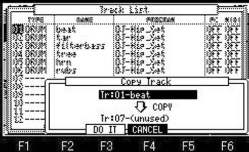
上のTrフィールドでコピーするトラックを選択し、下のTrフィールドでコピー先のトラックを選択したらF3(DO IT)キーを押してください。
