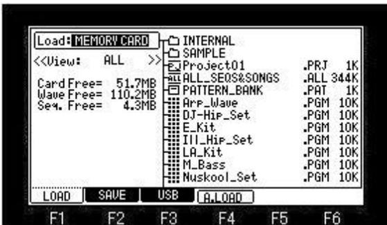
LOADの画面でF4(A.LOAD)キーを押すと"Auto Load"のウィンドウが表示されます。
