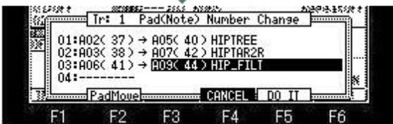
上図の場合、A02(37)のイベントはA05(40)に移動されます。A03(38)のイベントはA07(42)に移動されます。A06(41)のイベントはA09(44)に移動されます。
