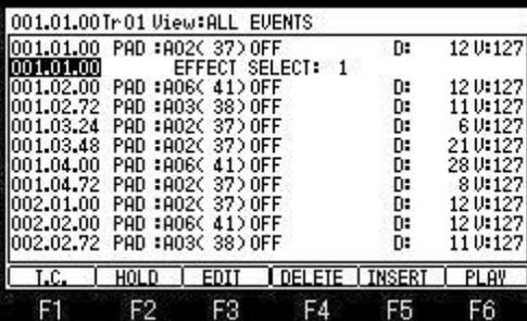
ステップエディットでプログラムチェンジを挿入したい位置でF5(INSERT)キーを押してください。
