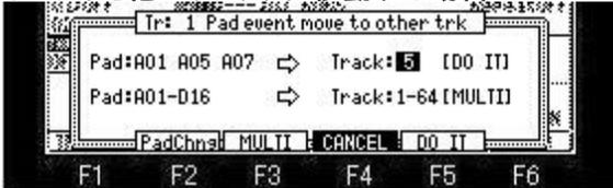
Padフィールドで移動させたいパッド番号を選択し、Trackフィールドで移動先のトラック番号を選択してください。上図の場合、トラック1のA01、A05、A07のパッド・イベントを全てトラック5に移動します。
