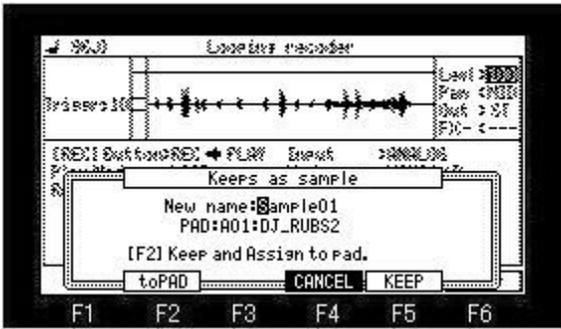
録音した演奏をサンプルとして残したい場合は "New name" フィールドで名前を付けて F5 (KEEP) キーを押してください。F2 (toPAD) キーを押すとサンプルとして残し、かつパッドに割り付けることができます。割り付けるパッドを PAD フィールドで選択したら F2 (toPAD) キーを押してください。パッドの選択は割り付けるパッドを叩いても選択できます。
